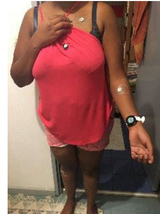
Mesures physiques embarquées sur l'occupant : humidité, température radiante et température d'air au voisinage du sujet
