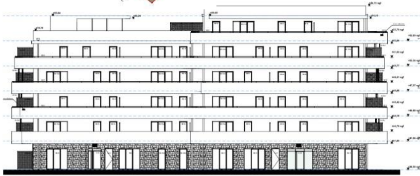
Casquettes formées par les balcons en façade SUD
