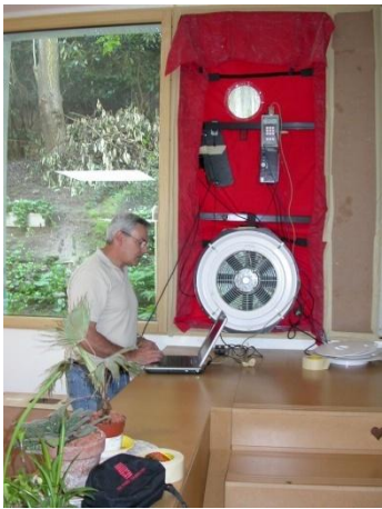
Porte soufflante (Blower Door)
