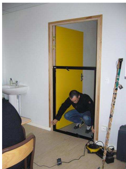
Adaptation du cadre de la fausse porte aux dimensions de la porte choisie pour le test
