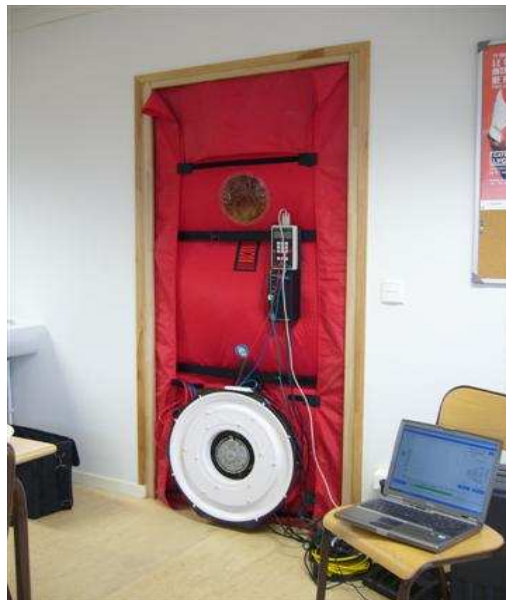
Installation de l'ensemble du dispositif de fausse porte à l'emplacement de la porte d'origine
