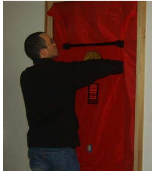
Installation de l'ensemble du dispositif de fausse porte à l'emplacement de la porte d'origine
