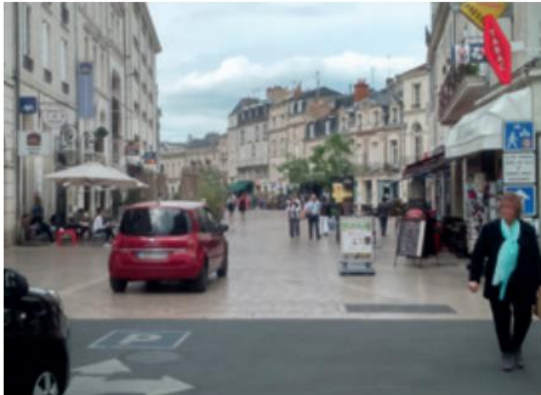
Ici, le changement de matériau sur la chaussée permet à la zone de rencontre de faire la transition entre l'aire piétonne et la zone 30, dans une rue commerçante.
