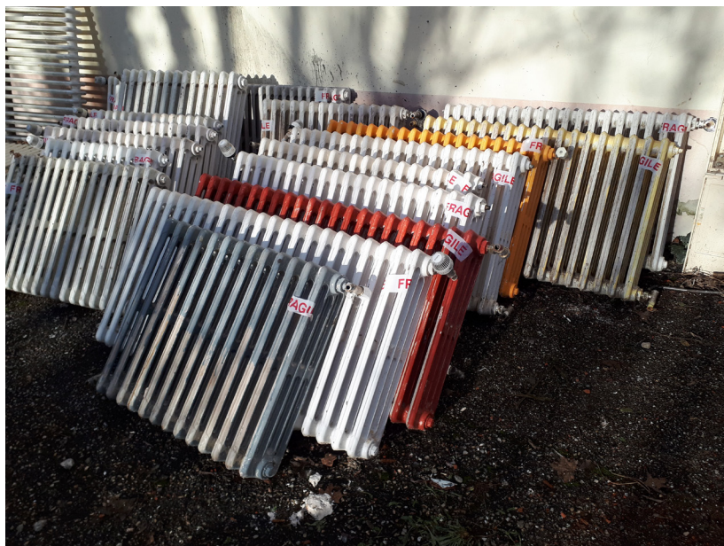
© Bobi Réemploi – Radiateurs en fonte déposés
