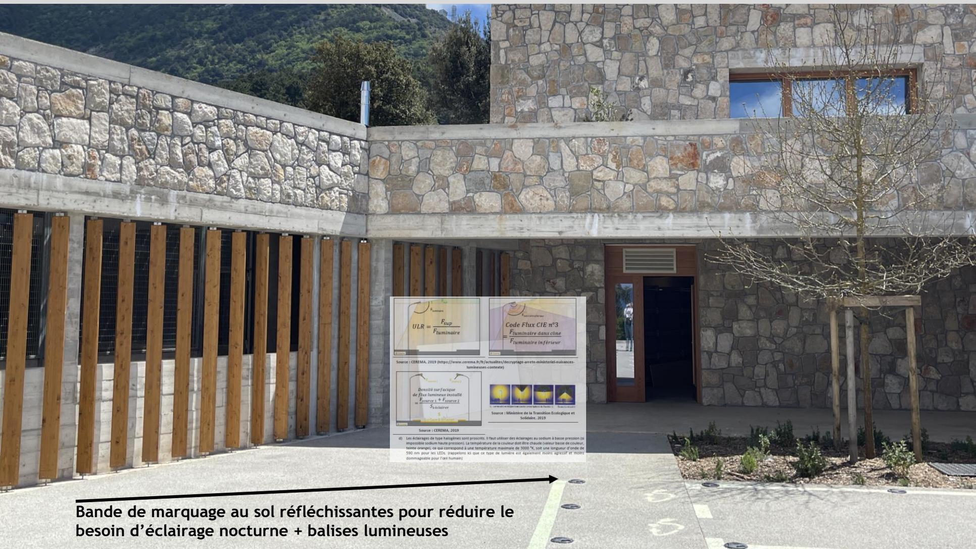
Bande de marquage au sol réfléchissantes pour réduire le besoin d'éclairage nocturne + balises lumineuses
