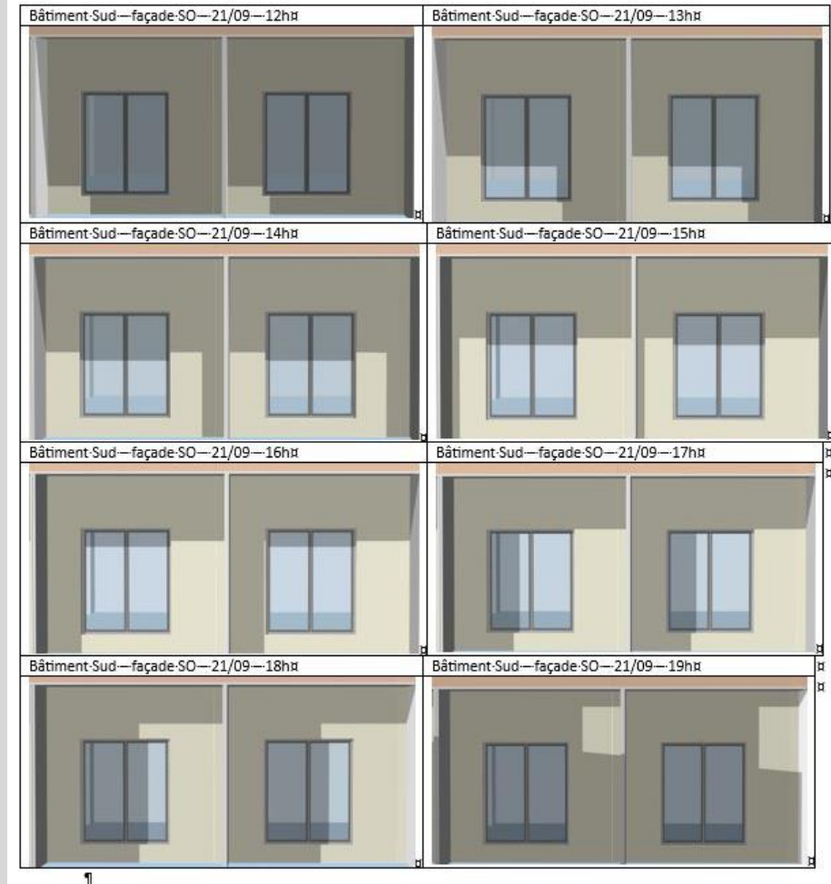
Bâtiment Sud—Façade SO—21/09
