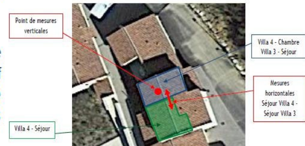
Figure 3 : Localisation des points de mesures du couple de Villas 3 et 4.
