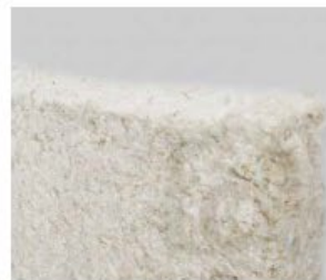
Isolation en biosourcé et recyclé (Biofib Trio pour le doublage et Mé-tisse pour les cloisons)
