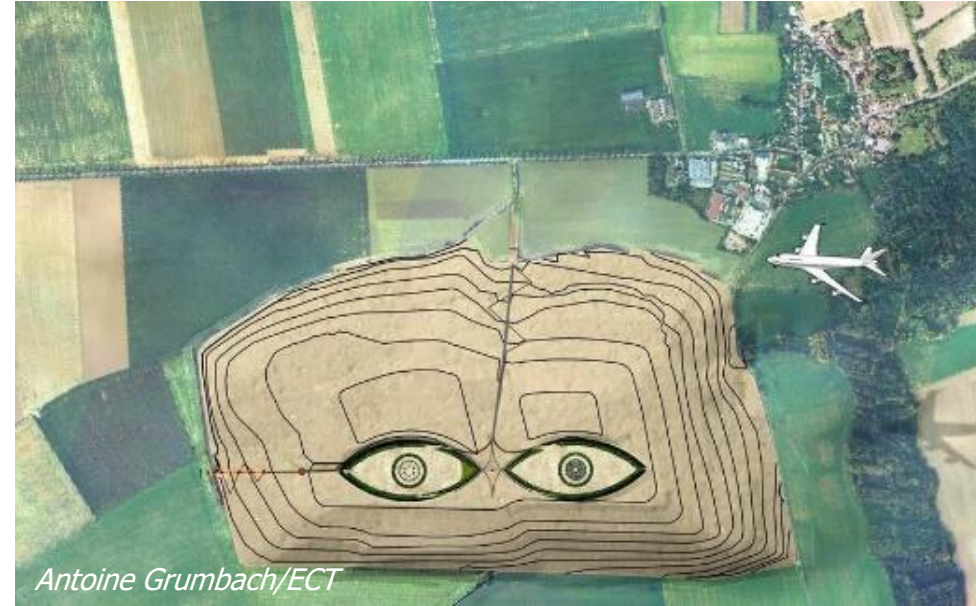
ISDI de Villeneuve-sous-Dammartin (77), emprise de 130 ha, 30 m de haut, un des 75 sites recevant les terres franciliennes
