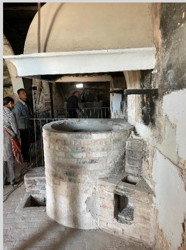
Four et bac de stockage eau grasse (récupération par savonneries)
