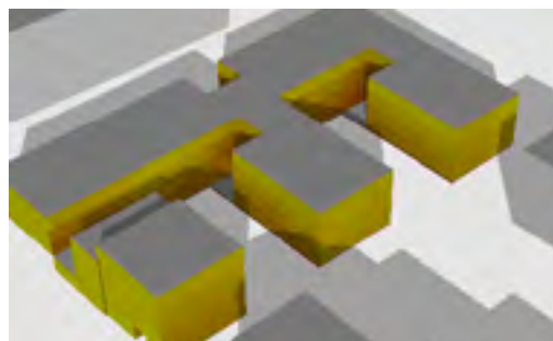
Modélisations sous Pleiades et analyse des ombres portées et insolation des façades.
