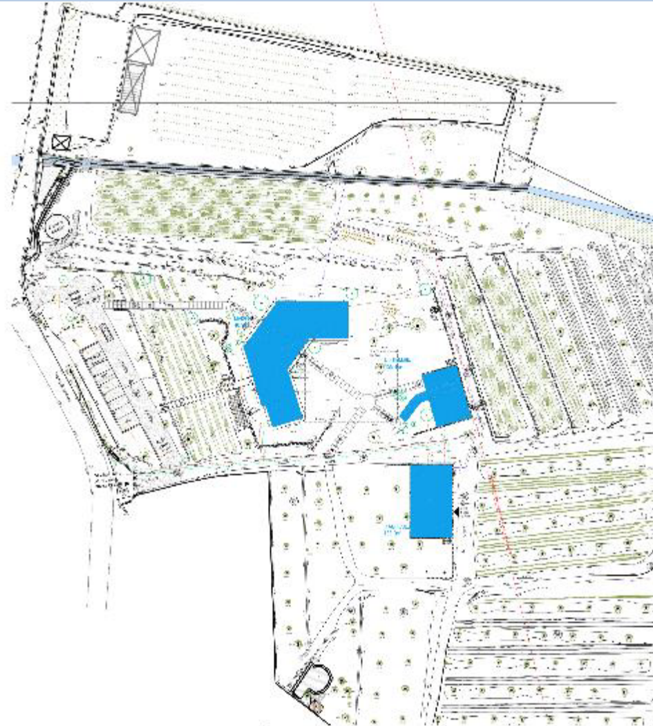
PROJET - SU IMPERMEABILISÉE : 731.6m 2
