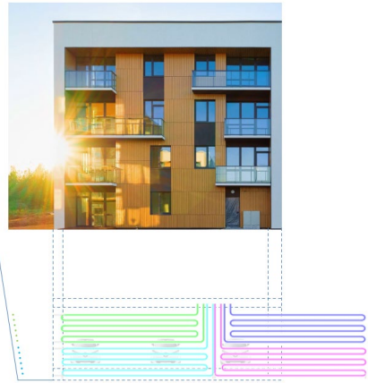
Géocooling Modélisation : géocooling implanté le long des murs des sous-sols, planchers rafraichissants
