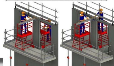
Phase 3 : - Pose de l'équerre aluminium depuis une PIR par 2 compagnons - Fixation à l'aide des 2 HUS (serrage complet) ou Tige arzon Ø17 + 1 écrou à rondelle flottante + 1 écrou à 2 ailettes coté équerre
