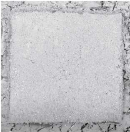
Les enduits qui poudrent manquent d'argile
