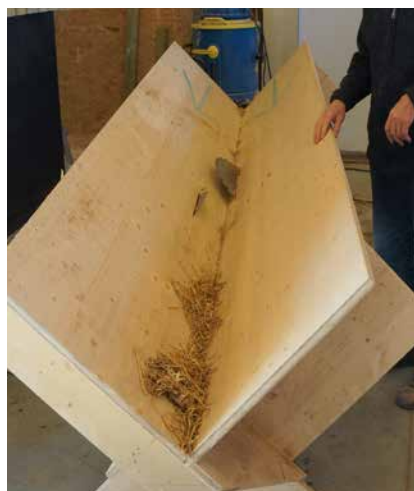
Banc de découpe de botte de paille pour caisson bois
