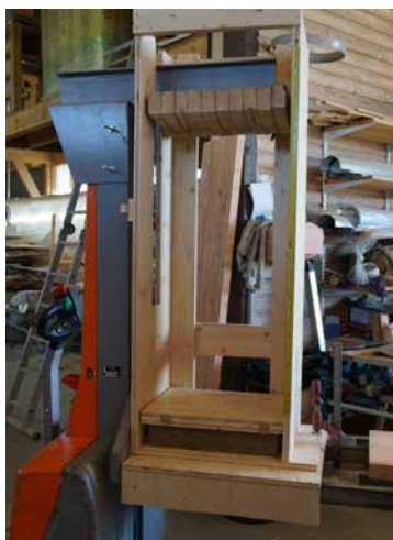
Presse de botte confectionnée avec un transpalette hydraulique
