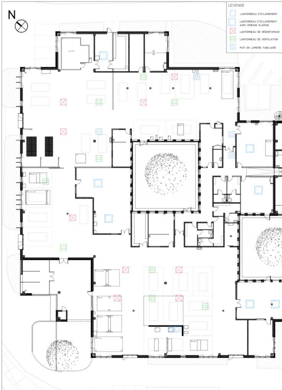
REPERAGE DES LANTERNEAUX DANS L'AILE OUEST
