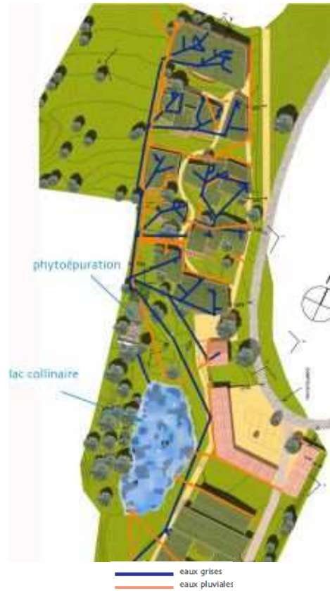
Plan des réseaux de récupération de l'eau
