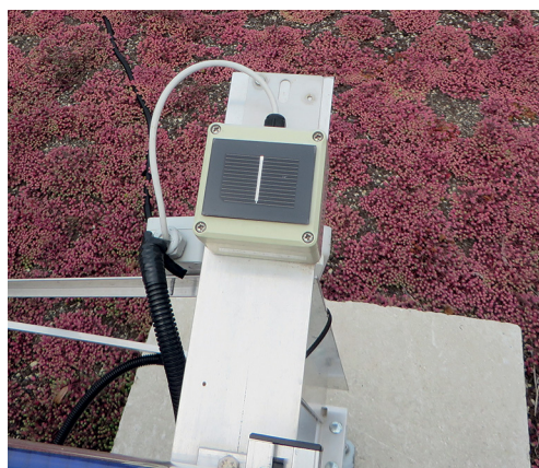
▲ Figure 10 : Capteur d'ensoleillement de type photovoltaïque (silicium)
