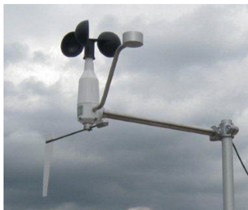
▲ Figure 11 : Centrale de mesure du vent avec anémomètre à coupelles et girouette
