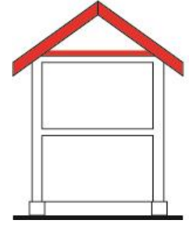
Isolation de toiture
