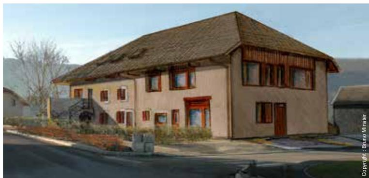
Réhabilitation et transformation en 7 logements locatifs d'un bâtiment communal situé au centre du chef lieu de Massingy. Le bâtiment, dont les façades sont en pierre, fera l'objet de travaux d'isolation. Il est également prévu l'installation d'une chaufferie bois et d'un système de ventilation mécanique. L'objectif est d'atteindre le niveau BBC en rénovation.
