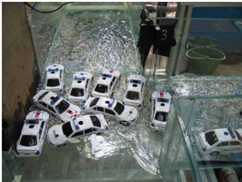
Figure 3 : Modification de l'onde de crue par des obstacles mobiles : photographie d'un essai en laboratoire (en haut ; échelle 1/24 e ) et évolution de la profondeur d'eau (en bas) dans la rue en l'absence (référence) et en présence de véhicules (source INSA Lyon).
