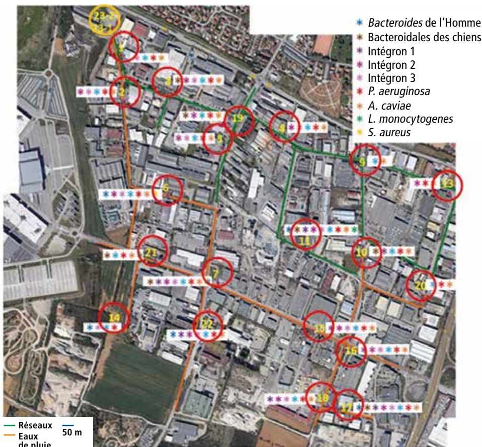
Figure 3 : Photo aérienne de la zone industrielle Mi-Plaine de Chassieu vers Eurexpo abritant une centaine d'entreprises, des restaurants, hôtels, mais également quelques parcelles agricoles. La photo permet d'apprécier le taux d'imperméabilisation du secteur d'étude et la densité du bâti. Les deux réseaux d'eaux pluviales (EP) de ce bassin-versant urbain sont représentés par les traits verts et orange. Ces réseaux ont comme exutoire un bassin de rétention et un système d'infiltration des eaux pluviales (nommé Django-Reinhardt). Les astérisques de couleur indiquent la répartition d'espèces pathogènes, de marqueurs de la contamination fécale ( Bacteroides de l'Homme ou du chien) et de supports génétiques de l'antibio-résistance (intégrons 1, 2 & 3), dénombrés par approches classiques avec des milieux sélectifs ou par approches moléculaires basées sur le suivi de signatures d'ADN. L'astérisque bleu ciel indique la forte prévalence d' E. coli et d'entérocoques intestinaux.
