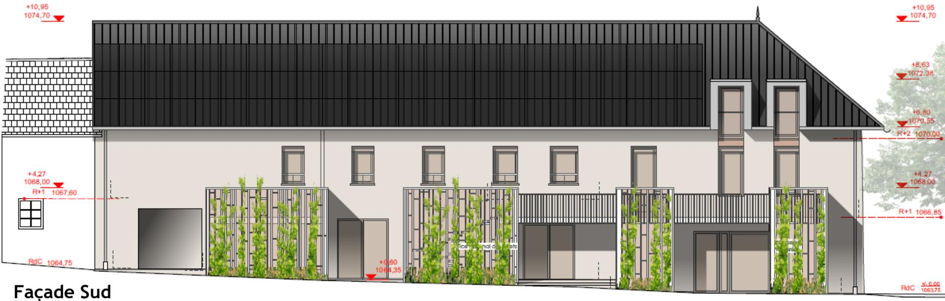
**Confort d'été et éclairage naturel** : En façade sud, de nouvelles baies sont créées suivant un ordonnancement préservant la composition de la façade existante. Elles sont protégées par des BSO dans les étages et des éléments fixes en bois au RDC
