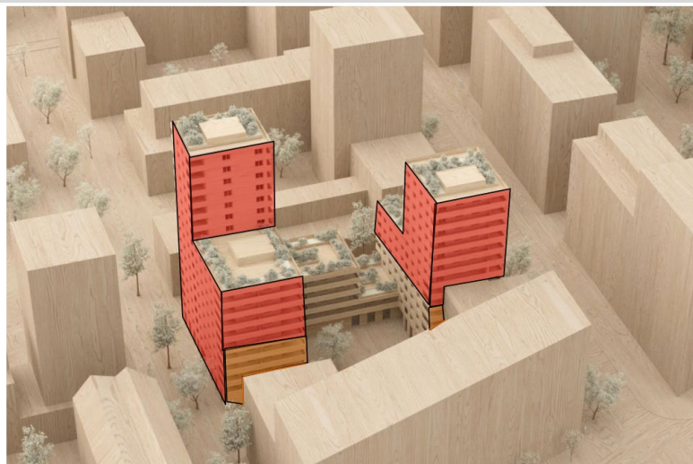
Façades Nord et Ouest impactée sur vue 3D - Vent tangent en orange, vent perpendiculaire ou tangent en rouge
