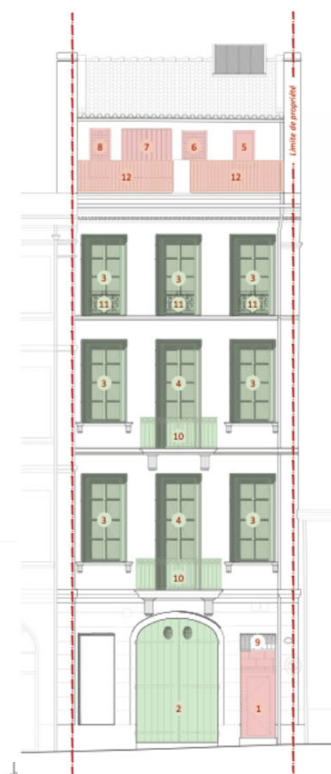
Repérage menuiseries et ferronneries extérieures
