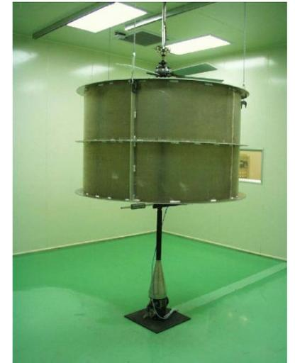
Tableau : Cylindre et chambre d'essai suivant ENERGY STAR® Testing Facility Guidance Manual
