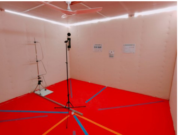
Cellule essai : Une cellule d'essai montée à Tours (37) d'une dimension de 4x4x2.5m, fermée et symétrique avec des parois verticales rigides, lisses et absorbantes. Pas d'obstacle pendant la mesure aérolrique, ajout de matériaux absorbant au sol pendant la mesure acoustique.
