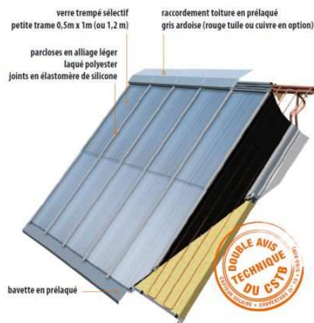
Capteurs solaires thermiques
