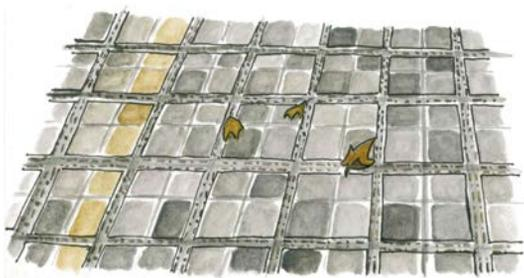
Bien que ce parking perméable avec chaussée réservoir permette une parfaite mutualisation des usages, la structure plastique est à bannir.
