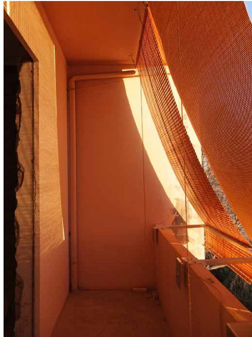
Echantillons posés depuis janvier 2024 pour vérifier la résistance aux intempéries des différents produits
