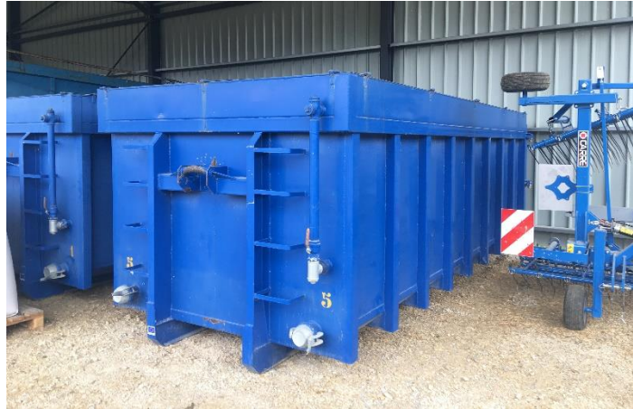
Photographie 9 : Photographie d'un caisson de distillation de lavande/in
