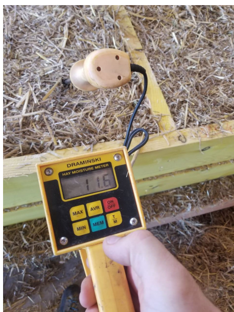
Test de l'humidité des bottes dans les murs © Lignatech
