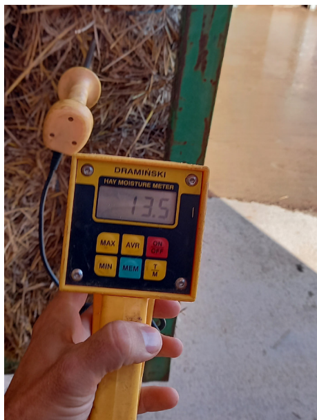
Test de l'humidité des bottes à l'arrivée dans l'atelier - © Lignatech
