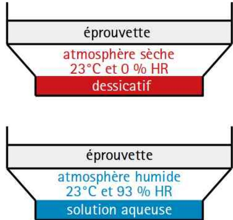
Identification de quantité d'eau diffusée en fonction de l'humidité relative moyenne de 25 % (coupelle sèche) et 71,5 % (coupelle humide)
