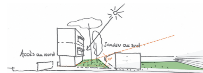
Sources : Croquis C. Dugontier Un travail graphique pour illustrer les principes L'implantation dans la pente, la densité, la forme urbaine, la topographie. Le potentiel de captage de lumière et de chaleur.
