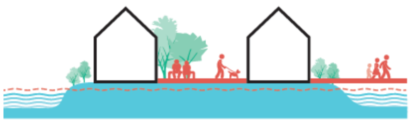
Construction sur socle remblais
