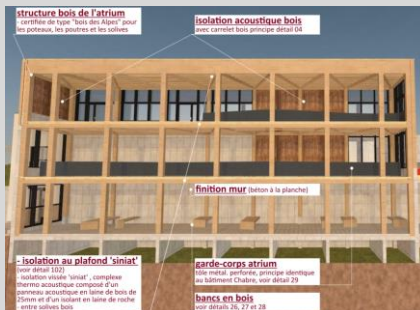
Atrium et puits de lumière Chabre en Bois des Alpes
