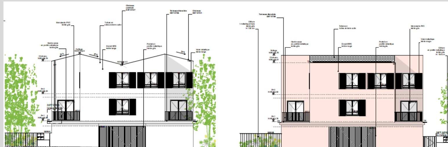
Des volets battants sur les façades Sud des logements intermédiaires (plots) et villas mitoyennes
