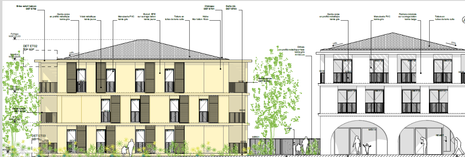
Des volets persiennés et roulant sur les façades Ouest des collectifs donnant sur la place
