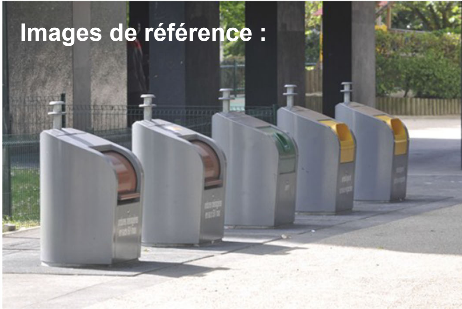
Tri des déchets et collecte dans des colonnes enterrées
