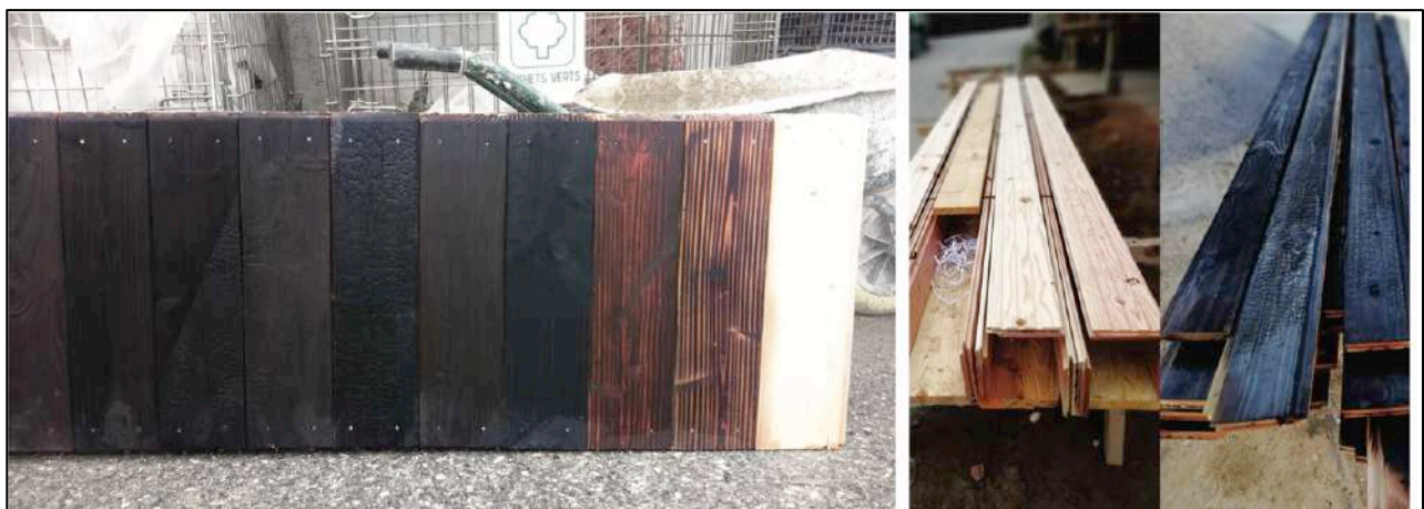
NA ! architecture, centre communautaire de santé à Échirolles - Essais de techniques de brûlage du bois, 2019
