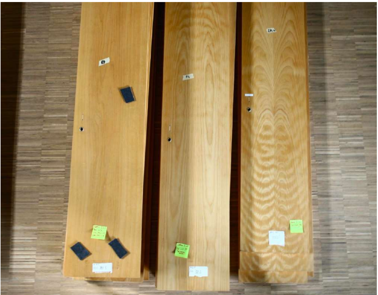
Rotor – Centre culturel de Bomel, étiquetage des planches pour faciliter le montage. Classement des motifs de veinage des planches
