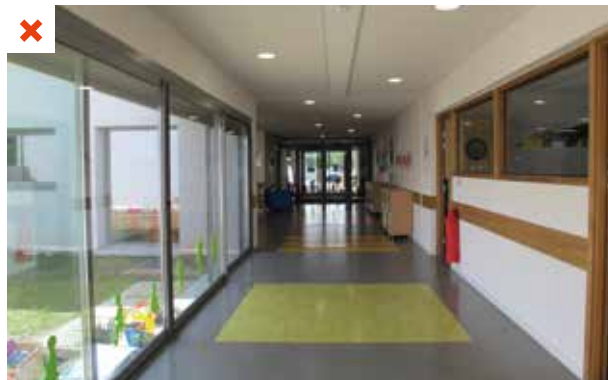
Plancher chauffant traditionnel en fonctionnement lors d'une journée ensoleillée. Les apports solaires vont se cumuler aux calories diffusées par le plancher et créer une surchauffe. De plus, même si le chauffage est coupé en début de matinée, le plancher reste trop chaud pour pouvoir valoriser de façon optimale les apports solaires. ©AQC
