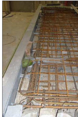
Fabrication des murs en usine : avant le coulage du béton et après décoffrage – source : De Jong Architectes
