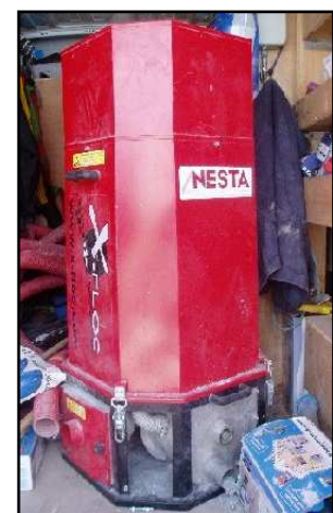
Machine servant à l'insufflation de la ouate de cellulose
