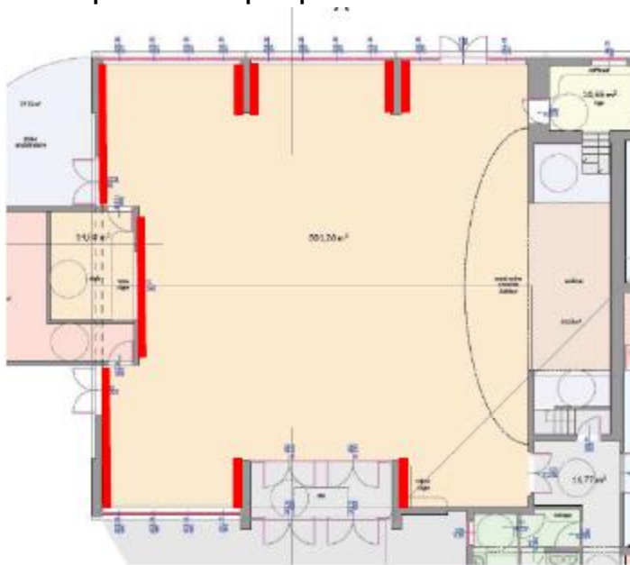
Figure 1 : Localisation des absorbants muraux dans la salle principale (en rouge)
