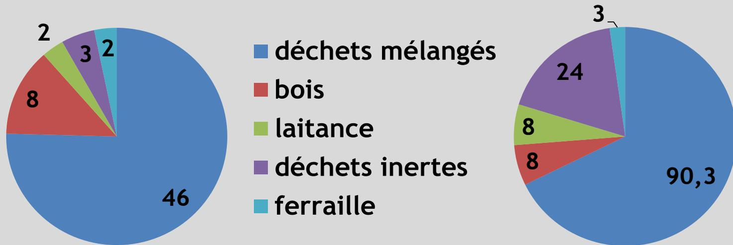
Ratio par m<sup>2</sup> SDP : 133 kg de déchets et 49cm ht !
