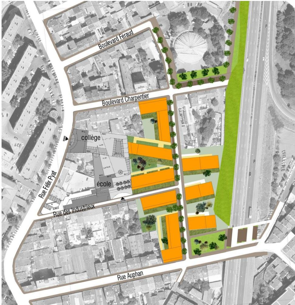
Afin d'assurer la cohérence d'ensemble du projet, l'opération Auphan Charpentier est soumise à des règles d'implantation précises, définies dans le cadre d'une zone à plan Masse (Cf. Règlement du PLU). Deux implantations différentes sont imposées pour ces îlots, une forme urbaine, en continuité des alignements bâtis existants; et des bâtis en peigne, perpendiculaires à la voie nouvelle.
