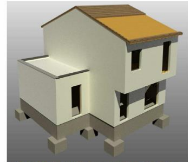
MISE EN PLACE ENVELOPPE & COUVERTURE AVEC RESERVATION PANNEAUX SOLAIRES
