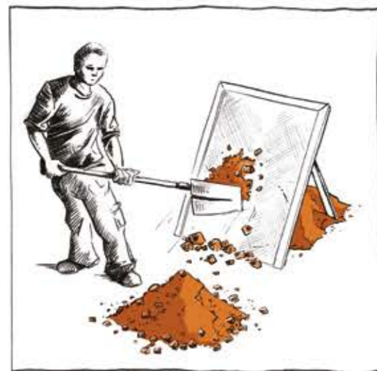
LA TERRE EST TAMISÉE POUR NE CONSERVER QUE LES ARGILES, LES SILTS ET LES SABLES.
