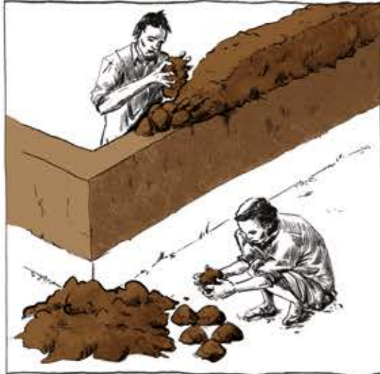
LE MÉLANGE EST ENVOYÉ DIRECTEMENT SOUS FORME DE BOULES MODELÉES À LA MAIN OU APPORTÉE DANS DES SEAUX OU DES PANIERS JUSQU'AU MUR À CONSTRUIRE.
