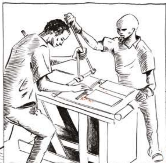
LA TERRE EST COMPRIMÉE MANUELLEMENT.
