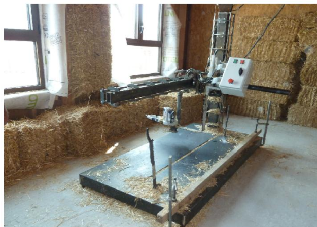
Machine de découpe pour paille à feuilletter (Source : Bergerie de la Berdine – Ostraka)
