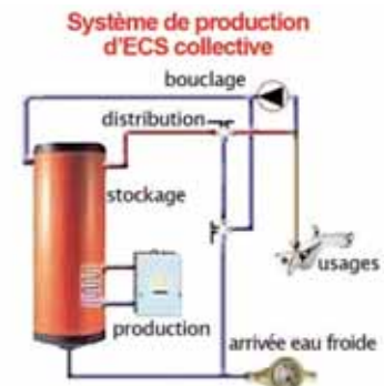
Schéma de bouclage [source CSTB]
